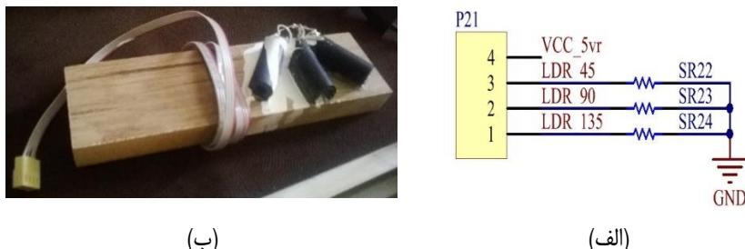
شکل ۳. (الف) مدار مکمل ورودی حسگرهای سه گانه، (ب) آرایش قرارگیری فتوسل‌ها
