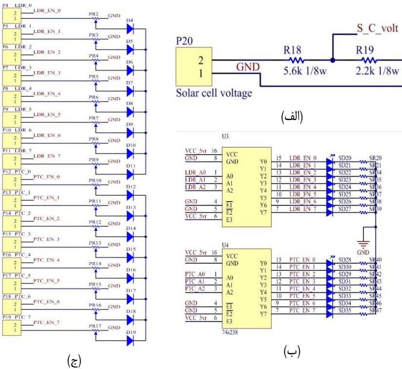
شکل ۴. (الف) مدار مکمل اندازه گیری ولتاژ صفحات خورشیدی، (ب) مدار تغذیه و رمز گشای ۸ حسگر ضمیمه فتوسل و ۸ حسگر فتوسل دما، (ج) مدار بازگشت و میکس اطلاعات برداشت شده از حسگرهای ضمیمه دما
