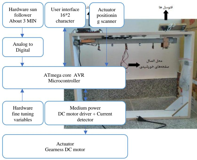
شکل ۱. تعقیب کننده خورشیدی: (الف) نمای کلی، (ب) بخش‌های مختلف و ارتباط بین آن‌ها
