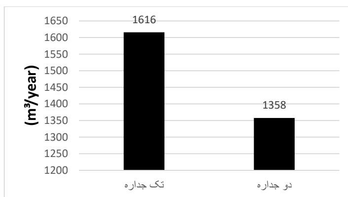
نمودار ۲ مقایسه بار حرارتی شیشه تک‌جداره و دوجداره
