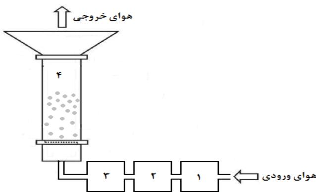
شکل ۱): طرح شماتیک خشک کن بستر سیال خورشیدی
