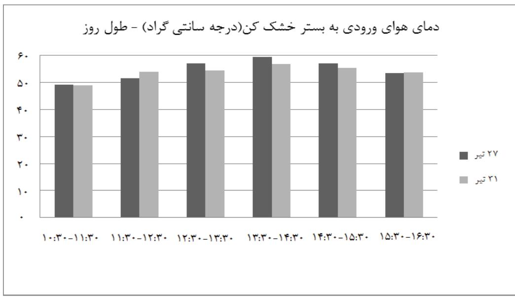
شکل ۵): میانگین دمای هوا ورودی به بستر خشک کن در ساعات ۱۰:۳۰ تا ۱۶:۳۰
