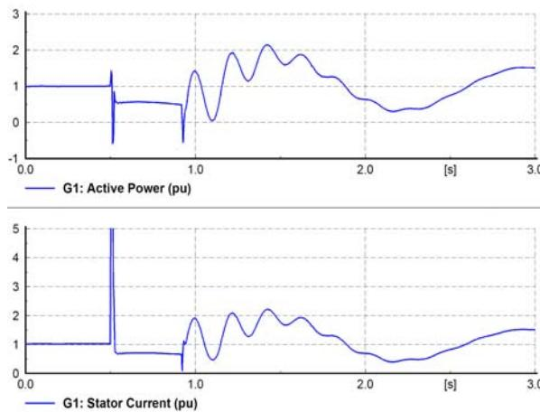
شکل(۷): تغییرات توان راکتیو و جریان ژنراتور در حالت استفاده از مقاومت ترمی، زمان قطع کلید ۲۰ میلی ثانیه و جبران‌سازی ۷۰ درصد
