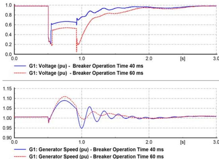
شکل(۹): نمودارهای ولتاژ و سرعت زنراتور برای دو حالت ۴۰ میلی ثانیه و ۶۰ میلی ثانیه تاخیر در عملکرد کلید و جبرانسازی ۱۰۰ درصد
