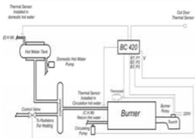
شکل ۳- طرح شماتیک نصب سیستم‌های کنترل هوشمند BC420
