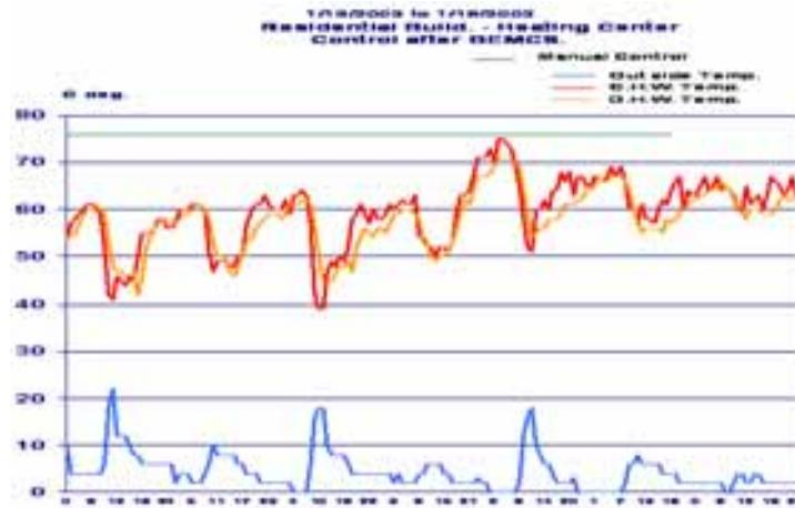
شکل ۶ - عملکرد سیستم کنترل هوشمند در یک موتورخانه مسکونی به مدت یک هفته از ۱/۱۳/۲۰۰۳ تا ۱/۱۹/۲۰۰۳
