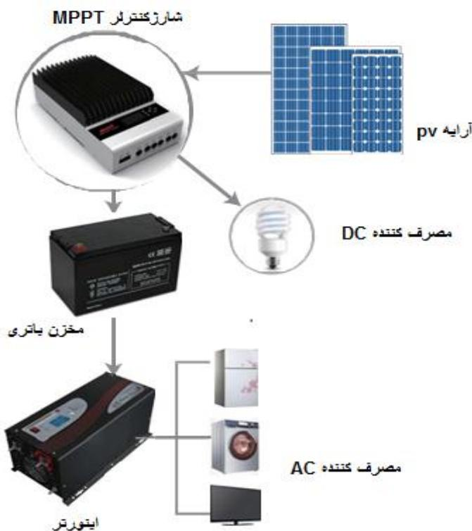
شکل ۲. طرحواره سامانه مستقل فتوولتاییک تولید برق.
