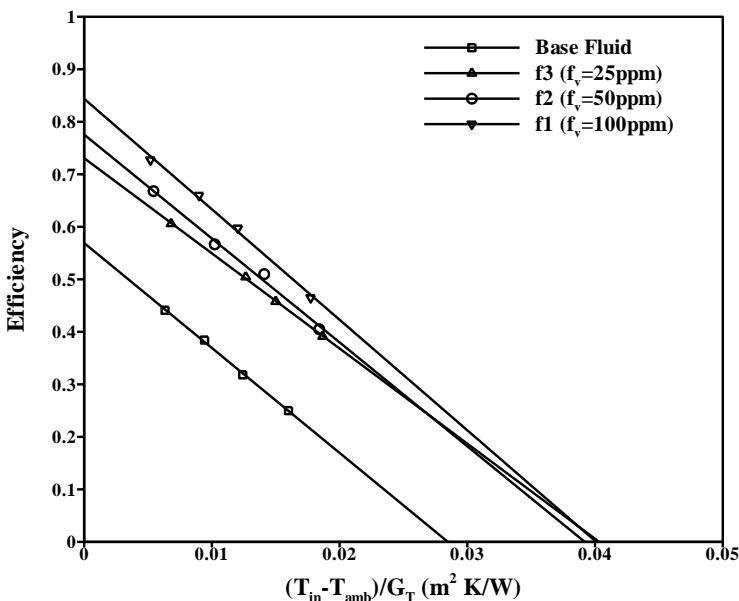
شکل ۶ تاثیر جزء حجمی نانوسیال نانولوله کربنی بر کارایی کلکتور جذب مستقیم در دبی  $72\text{ l/hr}$
