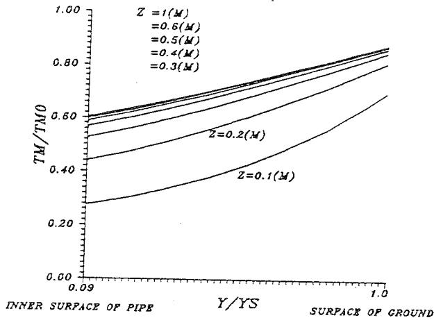
شکل ۷ - توزیع دما از مرکز لوله تا سطح لوله واقع بر پرتو شعاعی  $\theta = 0$  درجه در مقاطع مختلف امتداد محور شبکه پس از گذشت ۱۲ ساعت و ۷ دقیقه
