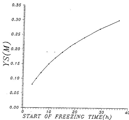
شکل ۴- ارتباط مابین عمق دفن لوله و مدت زمان آغاز انجماد وقتی که دمای هوای سطح زمین  $\frac{w}{m^2 \cdot k}$  ۲۰ باشد و ضریب جابجایی  $265/3$
