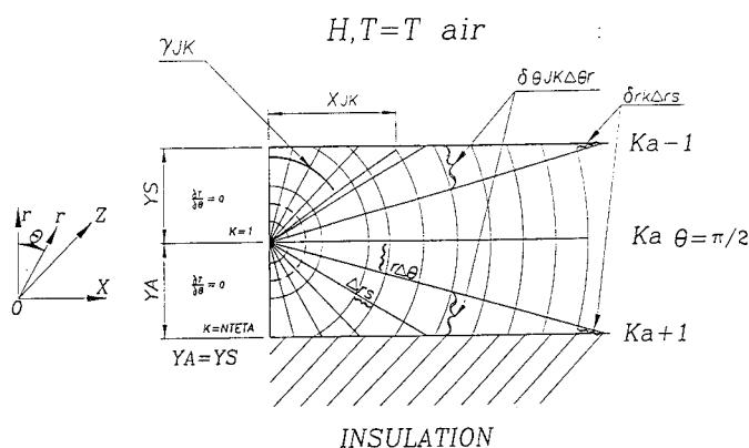
شکل ۱- ساختار نقاط تشکیل‌دهنده شبکه در صفحه  $r-\theta$
