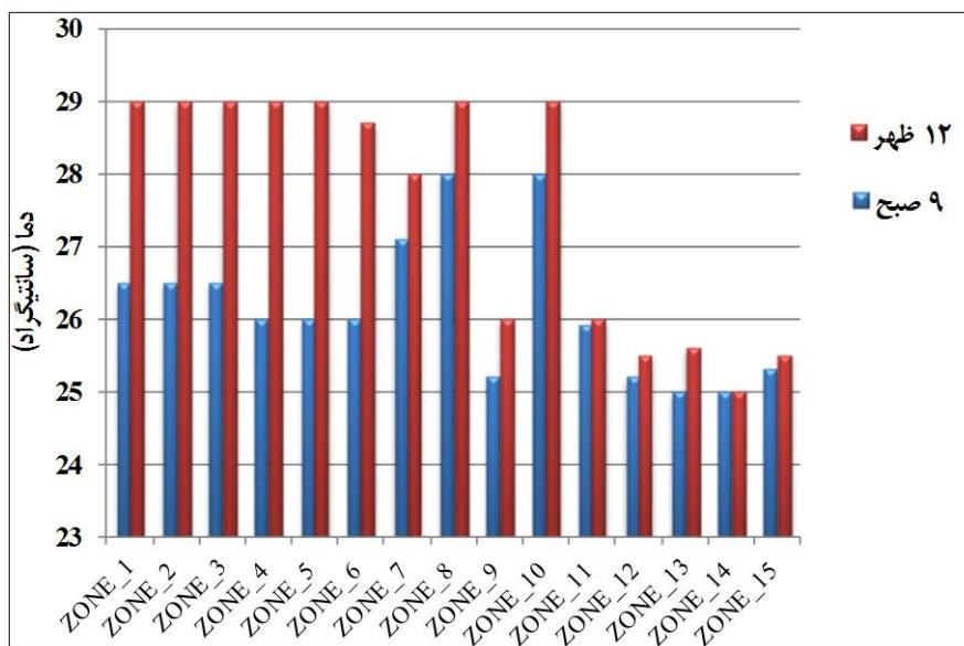
شکل ۶ مقایسه تست درجه حرارت در ساعت ۹ و ۱۲ در طبقه نهم
