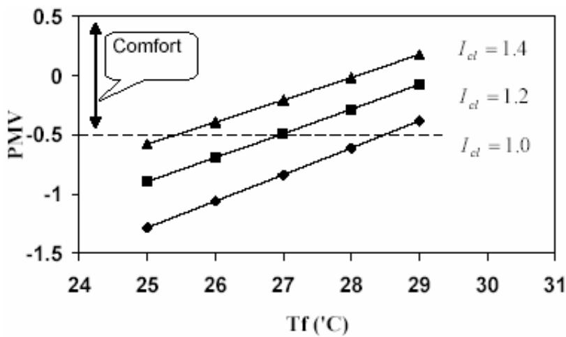
شكل ۴- احساس حرارتی افراد با تغییر میزان لباس،  $\varepsilon = ۰/۹۵$  و  $R_w = ۲ (m^2 K/W)$
