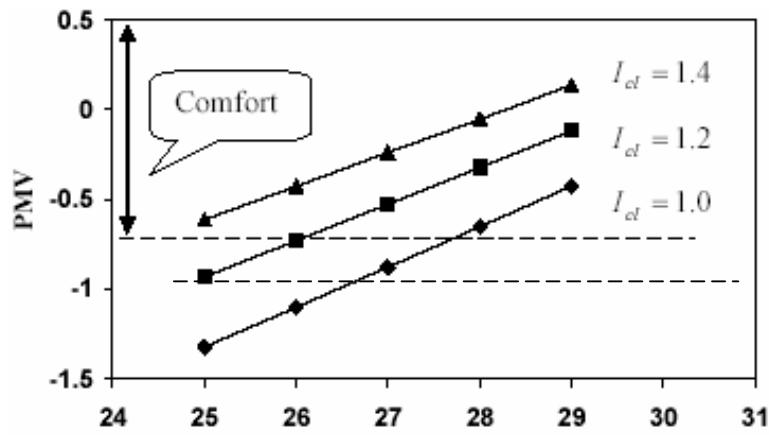
شكل ۳- احساس حرارتی افراد با تغییر میزان لباس،  $\varepsilon = ۰/۹$  و  $R_w = ۲ (m^2 K/W)$
