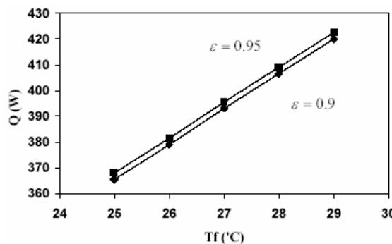
شکل ۲- اثر تغییر  $\varepsilon$  بر بار حرارتی اعمال شده به اتاق در ( $R_w = 4(m^2 K/W)$ )
