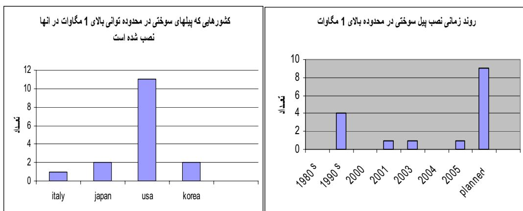
شکل(۴و۵): روند زمانی و محل نصب پیلهای سوختی نصب شده در محدوده توانی بالای ۱ مگاوات
