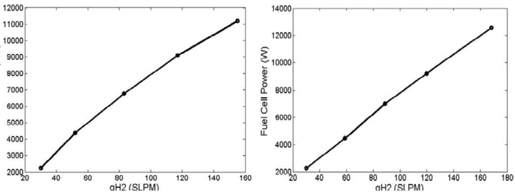
شکل (۲۳ و ۲۴): منحنی تغییرات توان پیل سوختی بر حسب تغییرات سوخت مصرفی سوختی برای هر دو پیل سوختی
