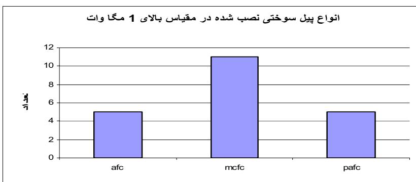
شکل (۳): انواع پیلهای سوختی خانگی، نیروگاهی نصب شده در جهان در محدوده توانی بالای ۱ مگاوات
