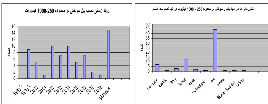
شکل(۶و۷): روند زمانی و محل نصب پیلهای سوختی نصب شده در محدوده توانی ۲۵۰ تا ۱۰۰۰ کیلووات
