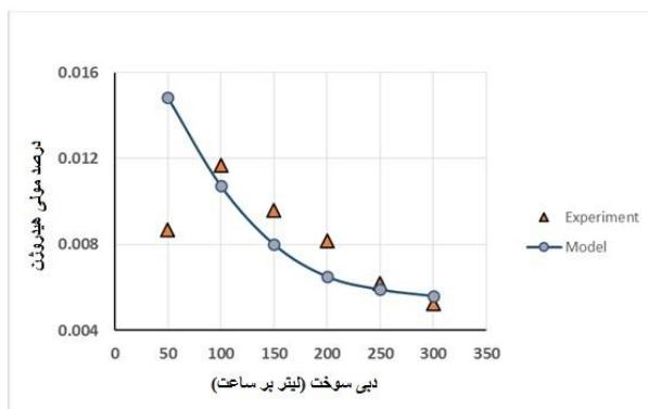
شکل ۹. تغییرات هیدروژن تولیدی در خروجی راکتور با قطر ۳۰ میلیمتر و طول ۳۰ سانتیمتر با نسبت همارزی ۲ برای دیهای مختلف سوخت
