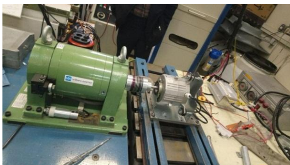
شکل ۶. دینامومتر نوع هیستریزیس مورد استفاده جهت تعیین بهره موتور بدون جاروبک
