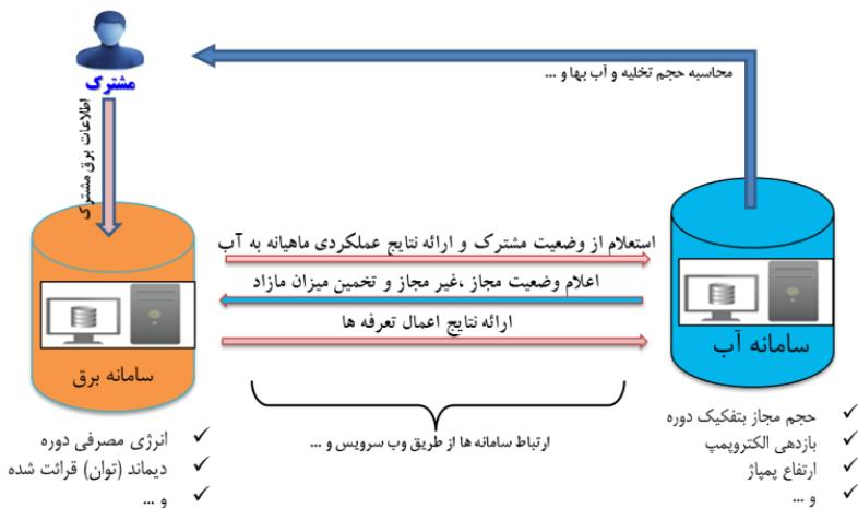
شکل ۶. نمونه‌ای بصری از ارتباط سامانه‌های بخش آب و برق برای تخمین حجم آب خروجی چاه با به کار گیری رابطه پیشنهادی
