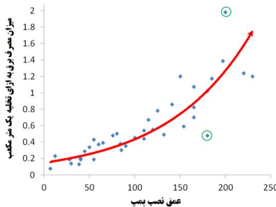
شکل ۳. منحنی برآورز شده از روی نمونه‌های شاخص  $\alpha_n$
