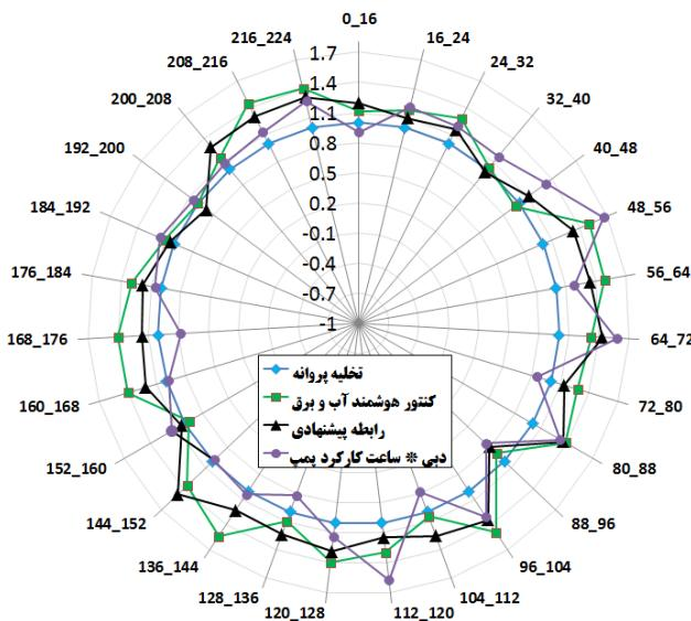
شکل ۷. میزان برداشت آب نرمالیزه شده نسبت به حجم مجاز پروانه (دایره واحد آبی رنگ) به تفکیک بازه عمق چاههای انتخابی (کلاسه‌بندی شده). برای اندازه‌گیری از طریق ۱. کنتور آب (نمودار سیز رنگ) ۲. اندازه‌گیری دبی و ضربان در ساعت کارکرد پمپ (نمودار با رنگ بنفش) ۳. روش پیشنهادی (نمودار سیاه رنگ).
