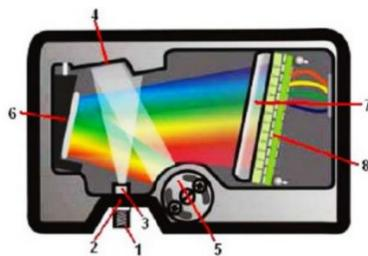
شکل ۲. ساختار درونی اسپکترورادیومتر. ۱) ارتباط با فیبر نوری، ۲) شکاف، ۳) فیلتر، ۴) آینه کولیماتور، ۵) شبکه انکساری، ۶) آینه متراکز، ۷) لنز جمع‌کننده آشکارساز، ۸) آشکارساز CCD.
