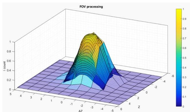
شکل ۱۱. میدان دید سه بعدی دهانه اپتیکی، در دو راستای زنیت و آزیموت و با دو حد تفکیک متفاوت  $1/0$  و ۱ درجه
