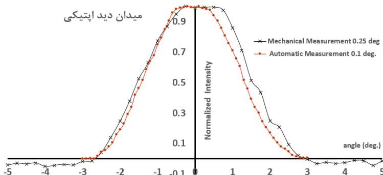
شکل ۱۲. میدان دید دهانه اپتیکی در راستای آزیموت که با استفاده از ابزار مکانیکی و هم به صورت اتوماتیک اندازه‌گیری شده است.
