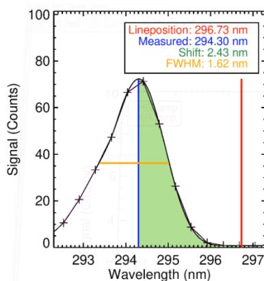
شکل ۱۵. تصحیح موقعیت مرکز طول موج متناسب با اندازه‌گیری‌های لامپ‌های کریپتون و جیوه مقدار جابجایی در تمامی طول موج‌های مذکور جهت اعمال تصحیحات طول موجی در شکل ۱۶ نمایش داده شده است.
