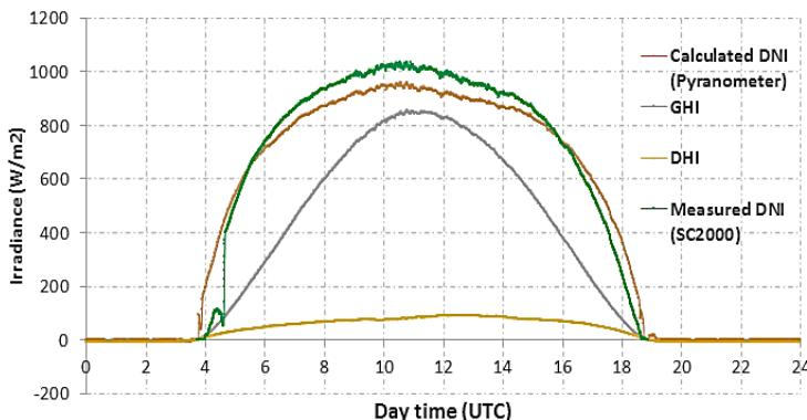
شکل ۱۸. مقادیر کمیت‌های اندازه‌گیری شده با پیرانومتر (شامل DNI، GHI و DHI محاسباتی) و اندازه‌گیری‌های DNI برمبانی سیستم عملیاتی حاضر که با استفاده از اسپکتروادریومتر SD2000 اندازه‌گیری شده است.
