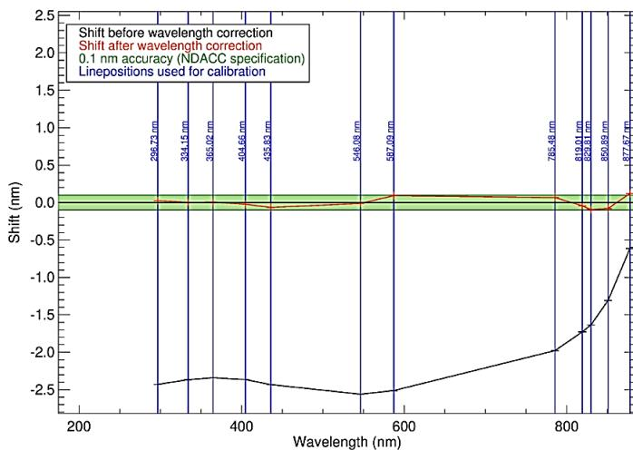
شکل ۱۶. مقدار جابجایی در طول موج‌های مختلف برای انجام تصحیح طول موج پس از اعمال تمامی تصحیحات و آنالیزهای کالیبراسیون مورد نیاز، مقدار SDNI اندازه‌گیری شد. مقدار SDNI اندازه‌گیری شده در طول یک روز کاملاً آفتابی و شرایط آسمان صاف (مورخ ۸ ماه می ۲۰۱۸) در منطقه مورد مطالعه به صورت یک منحنی سه بعدی (شکل ۱۷) قابل نمایش است.
