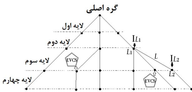
شکل ۱. یک نمونه سیستم توزیع ساعی
