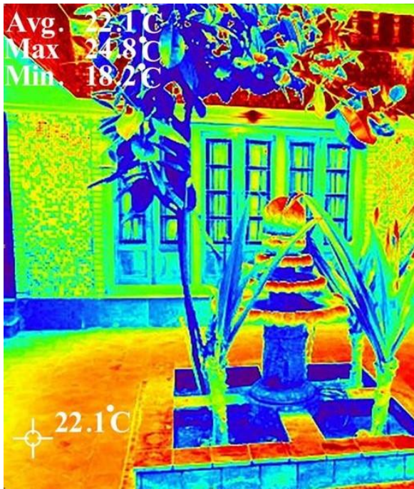
شکل ۲. تصویربرداری شده با دوربین حرارتی از بنای خواجه خضر در یزد (مأخذ: نتایج تحقیق) سطح ۲: قسمت همکف بنا که یک طبقه روی گودال باغچه قرار دارد.
