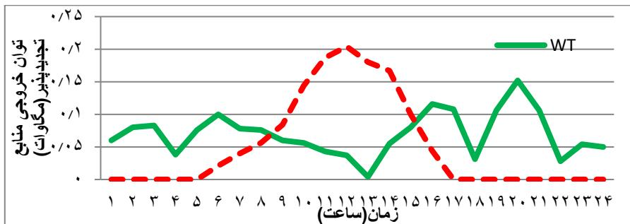
شکل ۴. توان خروجی توربین‌های بادی و پنل‌های فتوولتائیک هاب (وو<sup>۱</sup> و همکاران، ۲۰۱۷، "با تغییر")
