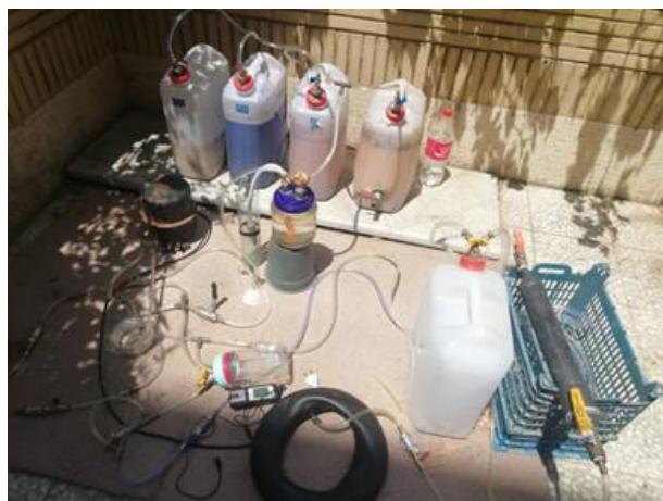
شکل ۱. سامانه آزمایشی تولید بیوگاز
