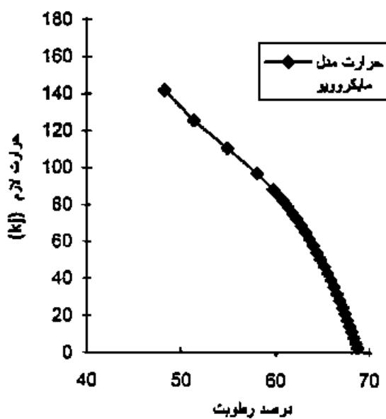
نمودار ۱۲- میزان حرارت لازم نسبت به کاهش درصد رطوبت در طول پخت مایکروویو
