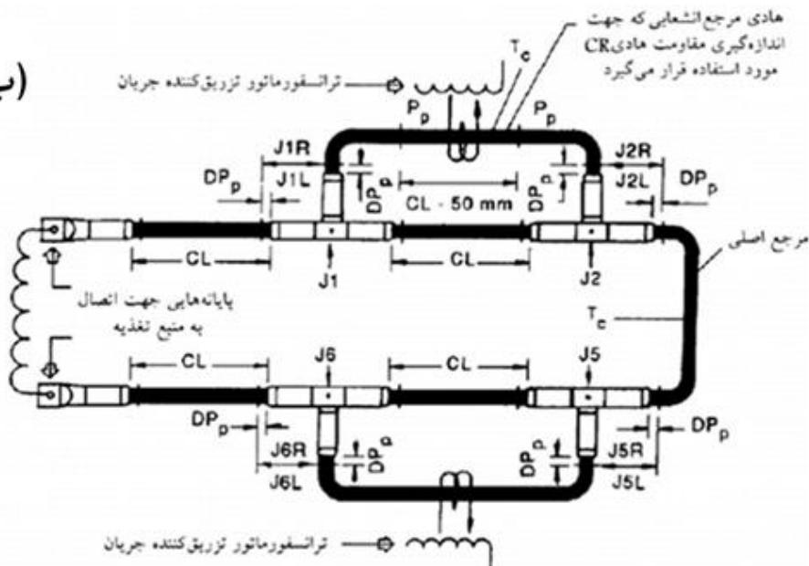
شکل ۳. مدار الکتریکی آزمون سیکل جریان/حرارتی برای بررسی تفییرات مقاومت الکتریکی/دمای اتصالات (الف) کششی (کلاس A) و (ب) غیر کششی (کلاس B) [۱۳]
