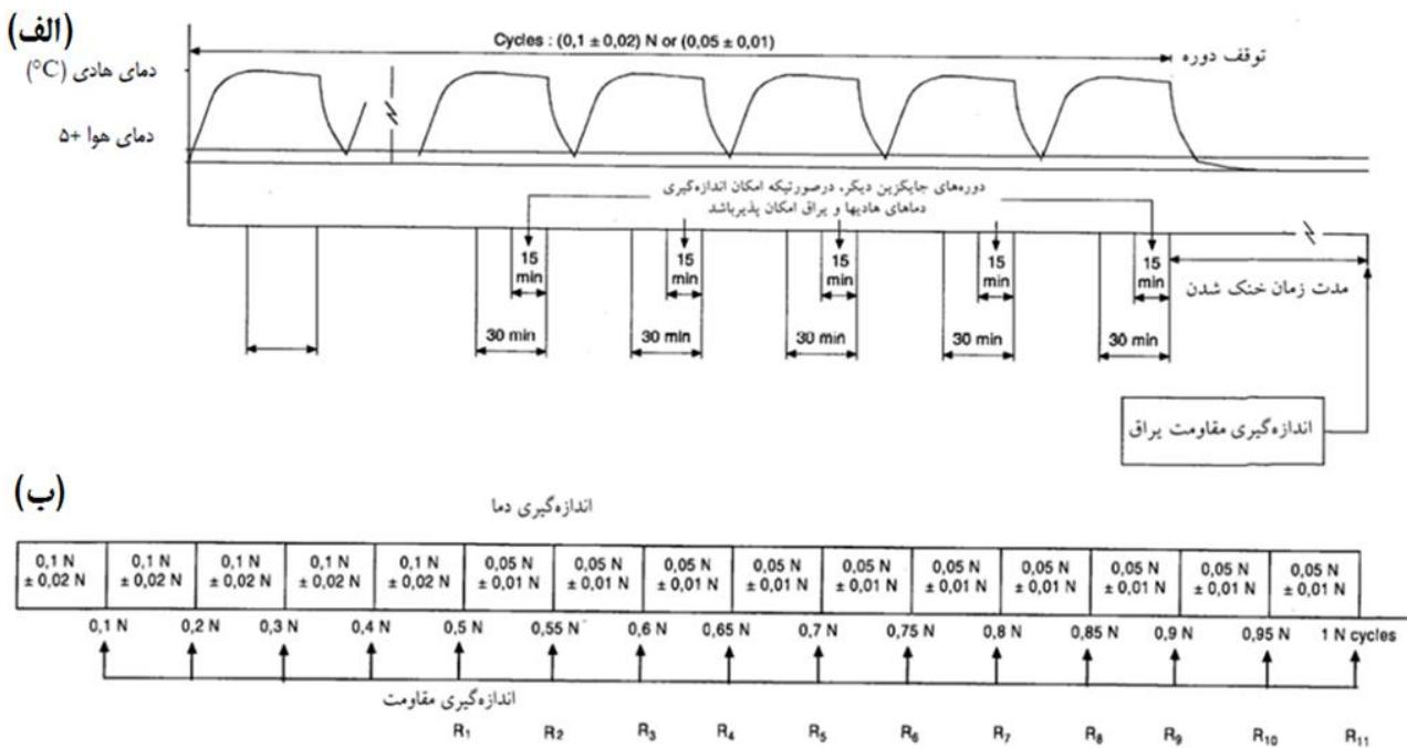
شکل ۴. (الف) سیکلهای جریان/گرمای اعمالی روی اتصالات در حین آزمون پیرسازی الکتریکی و (ب) بازه‌های زمانی اندازه‌گیری دما و مقاومت الکتریکی رابطه‌ها و هادی‌های مرجع [۱۳]
