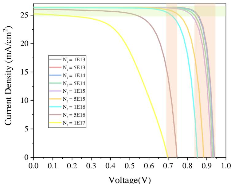
شکل ۴. نمودارهای چگالی جریان برحسب ولتاژ برای چگالی نقص‌های مختلف لایه پروسکایت.
