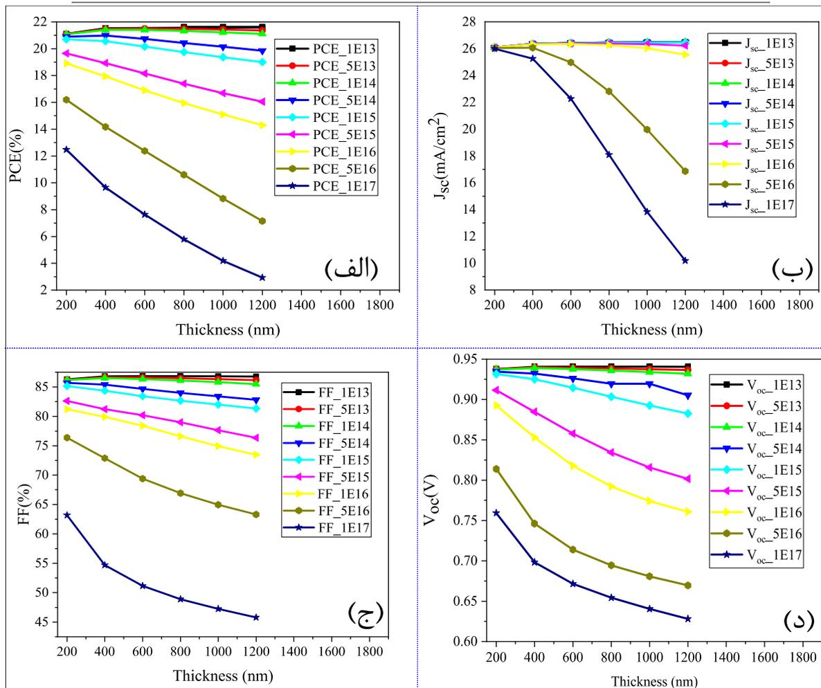
شکل ۵. تغییرات پارامترهای الف) PCE (ب)  $J_{sc}$  (ج) FF (د)  $V_{oc}$  نسبت به تغییرات ضخامت لایه جاذب پروسکایت برای تراکم نقص‌های مختلف.
