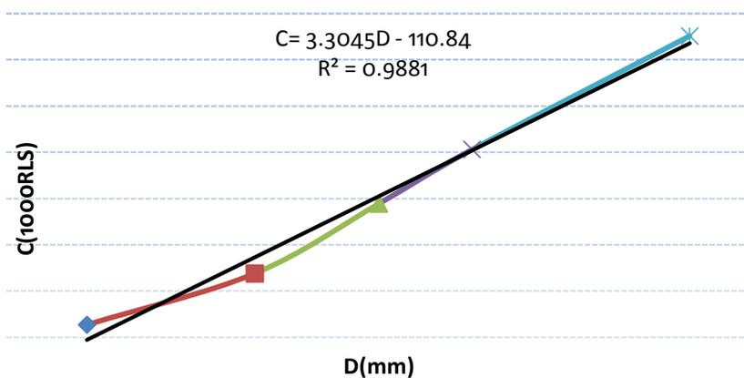
شکل ۳: هزینه لوله گذاری (C) به صورت ۱۰۰۰ ریال در واحد طول لوله (متر) بر حسب قطر لوله D(mm)
