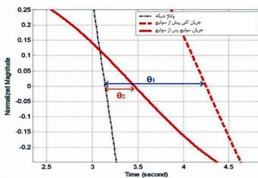
شکل ۵: زاویه بین ولتاژ و بردار جریان مدار در دو حالت
