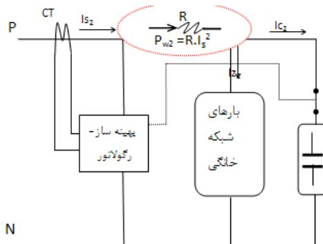
شکل ۳: سوئیچ خازن ها در شبکه توسط دستگاه
