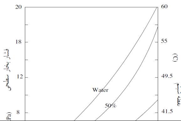
شکل ۳: فشار بخار سطحی در محلول آب-تری اتیلن گلایکل
