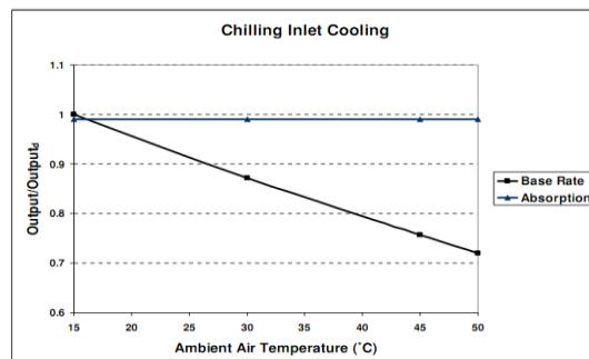
شکل ۱۴: تاثیر سیستم تبزید جذبی با دمای خروجی  $C = 15$  بر عملکرد توربین گازی
