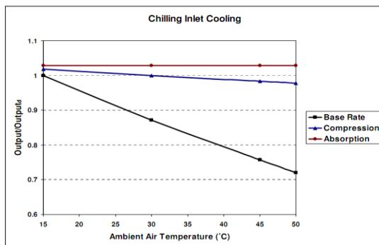
شکل ۱۵: تاثیر سیستمهای تبزیدی با دمای خروجی  $10^{\circ}\text{C}$  درجه سانتیگراد بر عملکرد توربین گازی
