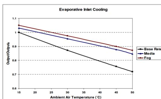
شکل ۱۳: تأثیر سیستمهای خنک کاری تبخیری در رطوبت نسبی  $30\%$  بر عملکرد توربین گازی
