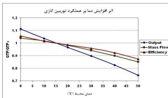
شکل ۱۲: تغییر پارامترهای واحد گازی در اثر افزایش دمای محیط ( $60\% = \text{رطوبت نسبی}$ )
