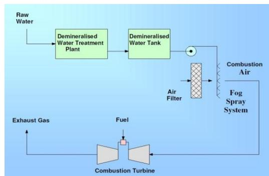
شکل ۲: شماتیکی از نحوه قرارگیری سیستم تبخیری فاگ در سیکل توربین گازی
