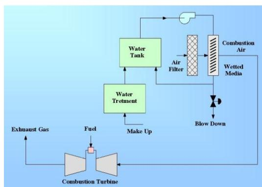
شکل ۱: شماتیک قرار گیری سیستم خنک کن مديا در سیکل توربین گازی
