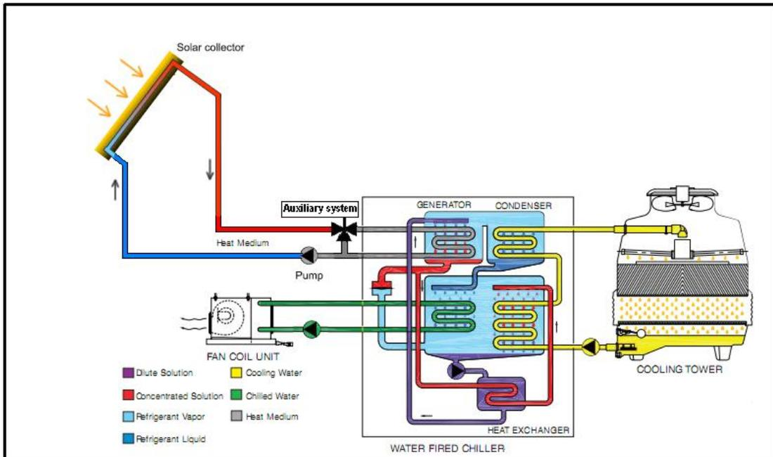
شکل ۵: شماتیک یک سیستم سرمایشی جذبی مجهز به سیستم خورشیدی
