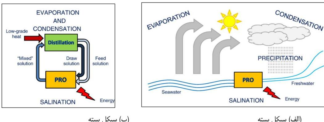
شکل ۲: شماتیک سیکل باز و بسته در تولید توان به روش PRO
