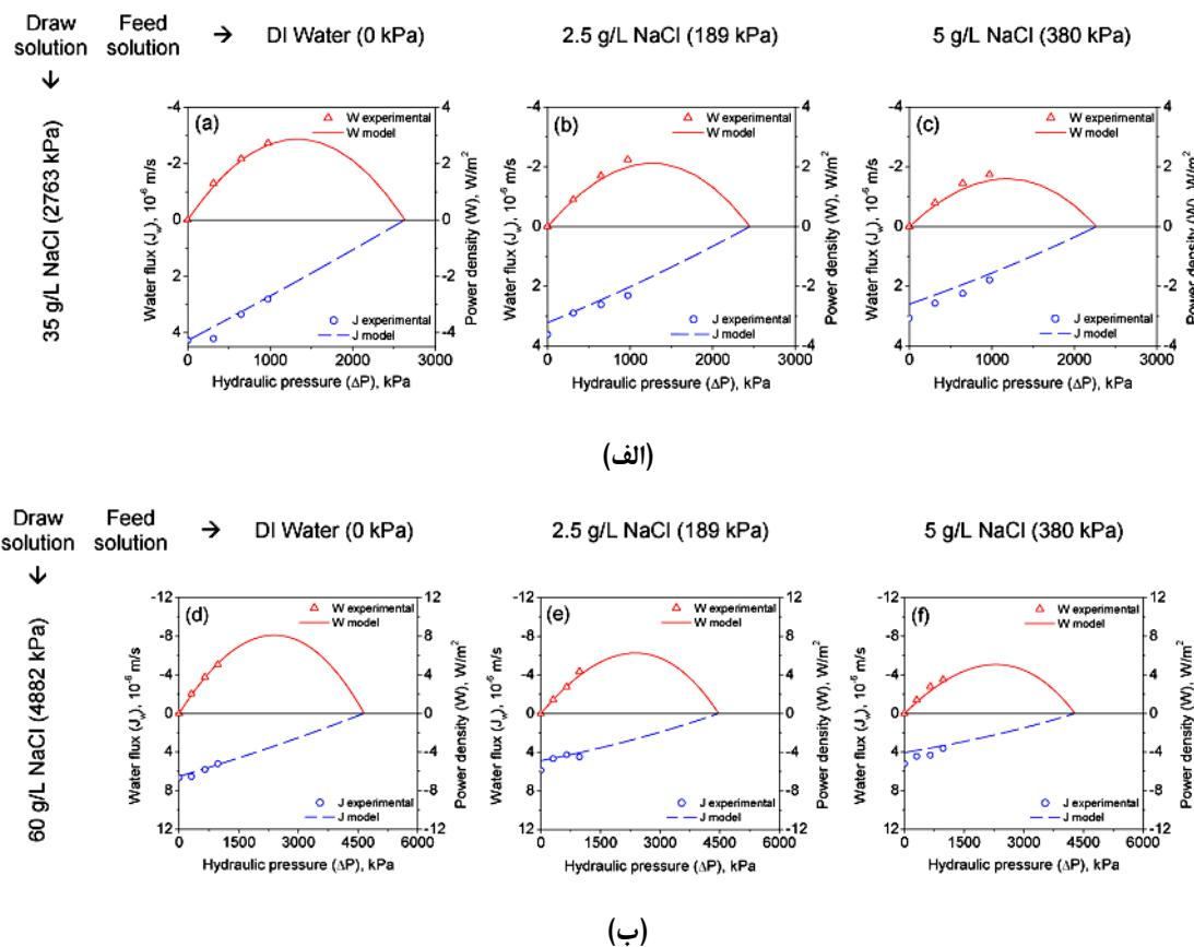
شکل ۹: مقایسه نتایج مدل با نتایج تجربی برای جریان آب عبوری از غشا ( $J_w$ ) و توان ویژه ( $W$ ) به صورت تابعی از فشار هیدرولیکی کاری  $\Delta P$ . جریان غلظت آب شور در شکل (الف)  $35\text{g/L}_{\text{NaCl}} 2763\text{kPa}$  و شکل (ب)  $60\text{g/L}_{\text{NaCl}} 4882\text{kPa}$  (۴۸۸۲)
