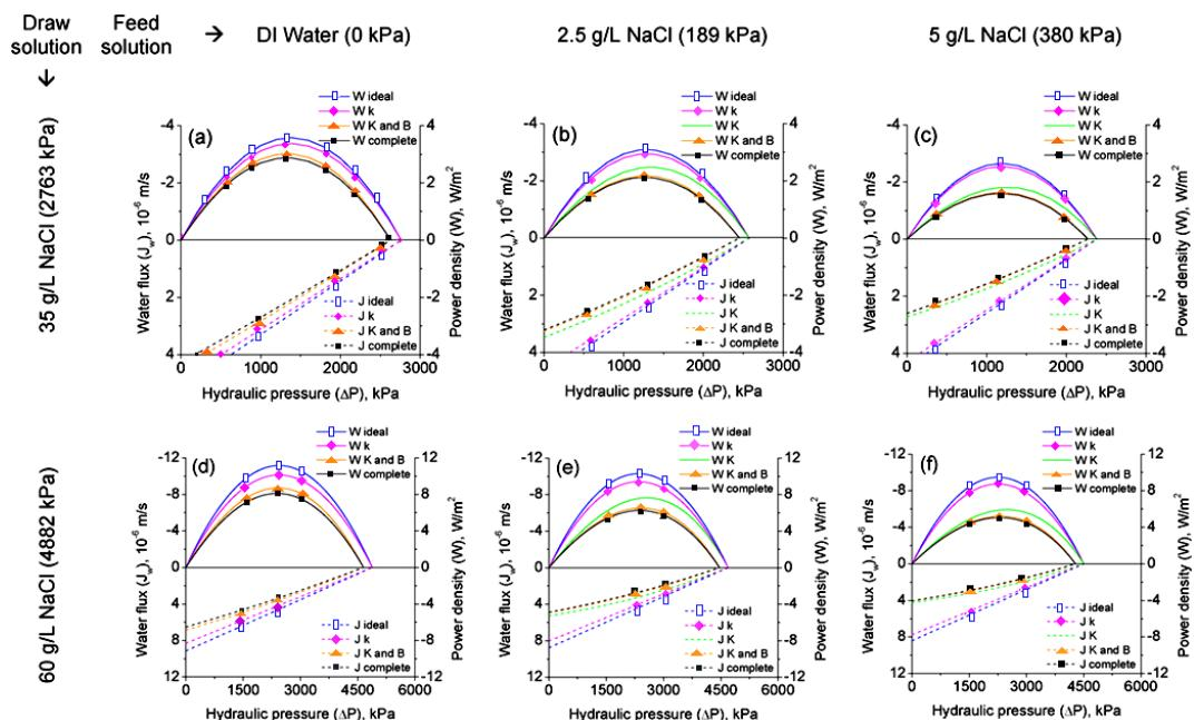
شکل ۱۰: نتایج مدل برای جریان آب عبوری از غشا ( $J_w$ ) و توان ویژه (W) به صورت تابعی از فشار هیدرولیکی کاری برای غلظت‌های مختلف جریان خوراک و آب شور  $\Delta P$
