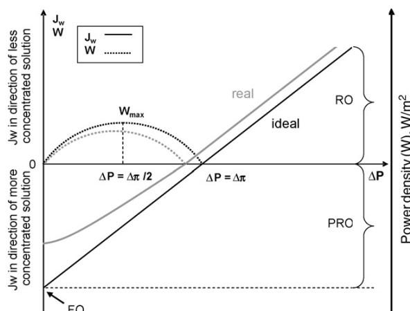
شکل ۶: اندازه و جهت جریان آب عبوری از غشا (J<sub>w</sub>) و اندازه توان ویژه (W) در روش‌های FO و PRO و RO
