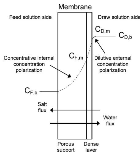
شکل ۸: نمایش یک غشای نامتناظر در روش PRO با قطبش غلظت داخلی و خارجی و نمایش جهت جریان و نمک
