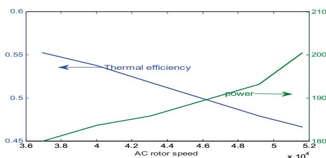
شکل ۸: اثر دور کمپرسور بر توان و راندمان سیستم
