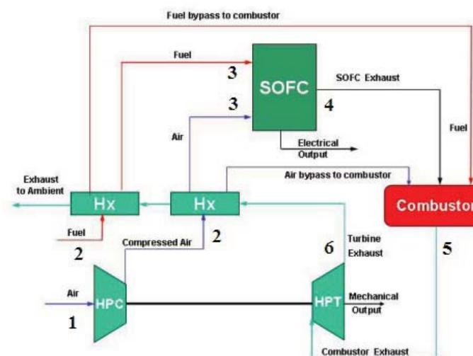
شکل ۱): نمایی از سیستم ترکیبی توربین گاز با پیل سوختی [۱۶]
