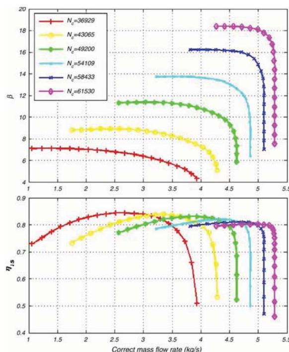
شکل ۲) نمایی از منحنی عملکرد کمپرسور [۳]
