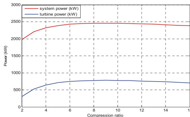
شکل ۵): اثر نسبت فشار بر روی توان تولیدی توربین و سیستم ترکیبی در نقطه طراحی در دمای  $1250\text{ K}$  کلوین
