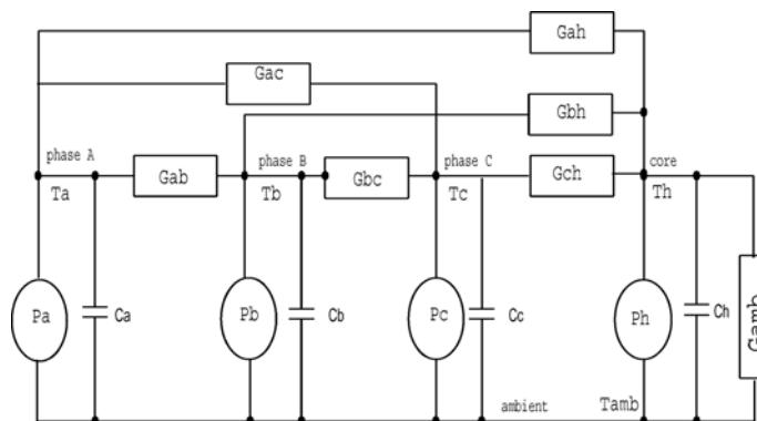
شکل ۶): مدار معادل مدل حرارتی استاتور موتور القائی
