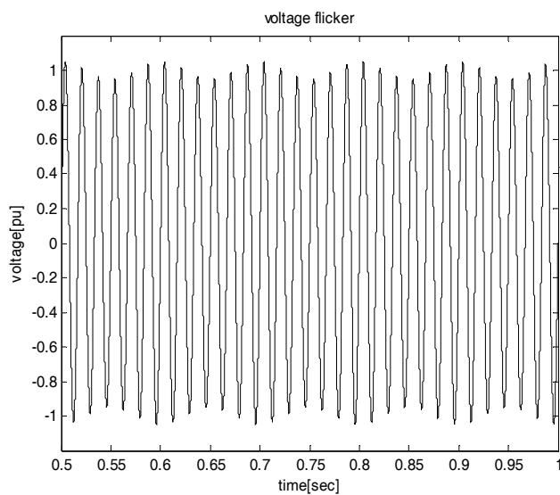
شکل ۱): نوسانات ولتاژ با فرکانس مدولاسیون  $f_m = 10\text{Hz}$  و دامنه مدولاسیون  $k_1 = 0.05$
