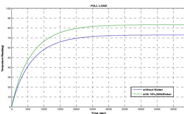
شکل ۷): مقایسه افزایش دمای محاسبه شده در دو حالت بدون نوسان ولتاژ و با نوسان ولتاژ با اعمال دامنه فلیکر ولتاژ ۸ درصدی و فرکانس فلیکر ۲۵ هرتز
