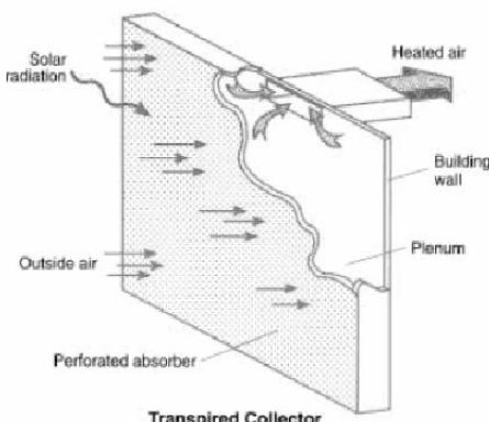
شکل ۱: شکل شماتیک کلکتور بدون شیشه با صفحات مشبك
