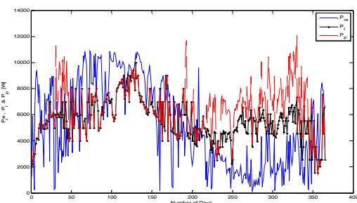
شکل ۱۱: توان تولیدی توسط سیستم ترکیبی خورشیدی-دیزلی ( $P_p$ )، توان تولیدی توسط منابع تجدید پذیر ( $P_{re}$ )، توان مورد نیاز بار ( $P_d$ )
