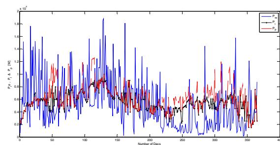
شکل ۲۱: توان تولیدی توسط سیستم ترکیبی خورشیدی- بادی- دیزلی ( $P_p$ )، توان تولیدی توسط منابع تجدید پذیر( $P_{re}$ )، توان مورد نیاز بار( $P_l$ )
