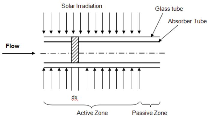
شکل ۵: مقطعی از لوله کلکتورها
