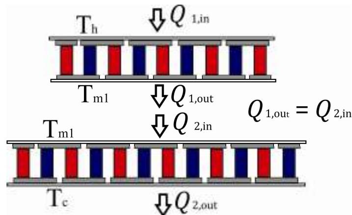
شکل ۶) گرماهای ورودی و خروجی برای هر مرحله از سیستم ترموالکتریک دومرحله‌ای و شرط ترمودینامیکی مربوطه با توجه به شکل (۶) و در نظر داشتن شکل ۴ (الف)، روابط حاکم بر سیستم دو مرحله‌ای موازی به صورت روابط (۵) تا (۱۰) در می‌آید:
