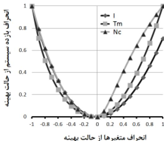
شکل ۱۵) حساسیت بازده سیستم ترموالکتریک به متغیرهای بهینه‌سازی
