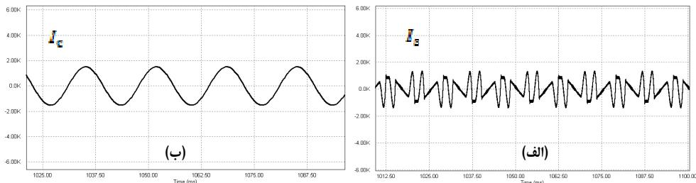
شکل ۱۰) روش آشکارسازی هارمونیکی با فیلتر میان‌گذر؛ (الف) جریان جبران‌سازی شده منبع، (ب) جریان تزریقی اینورتر از مزایای این روش، تاثیرناپذیری جریان مرجع از عدم تعادل و اعوجاجات ولتاژ تغذیه می‌باشد. سادگی پیاده‌سازی روش و عدم نیاز به محاسبات پیچیده از دیگر محاسن آن است.
