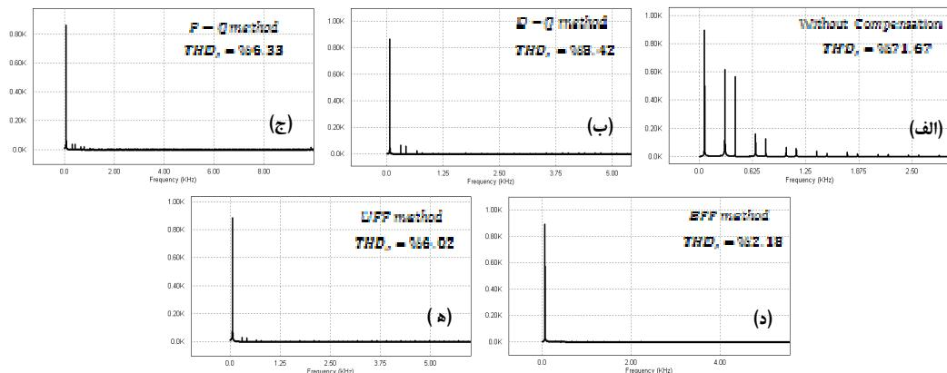
شکل ۱۵) طیف هارمونیکی جریان خط؛ (الف) پیش از جبران سازی، (ب) با روش دستگاه مرجع سنکرون D-Q ، (ج) با تئوری توان راکتیو P-Q ، (د) روش جداسازی مولفه اصلی با فیلتر میان گذر (BPF) ، (ه) روش ضریب توان واحد (UPF)
