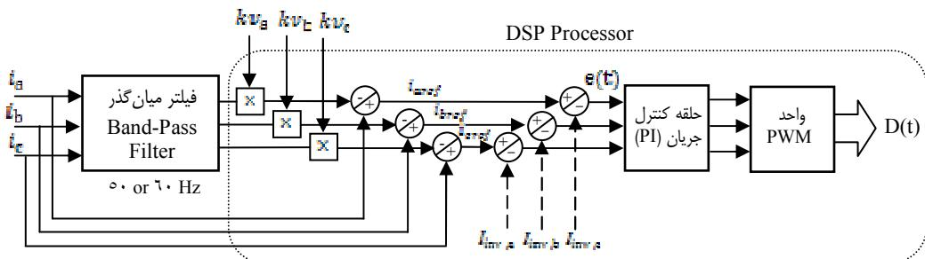
شکل ۸) ترسیم بلوکی روش آشکارسازی هارمونیکی با فیلتر میان‌گذر (BPF)
