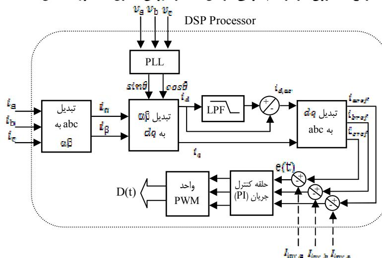
شکل ۵) ترسیم بلوکی مراحل تولید جریان مرجع با استفاده از روش دستگاه مرجع سنکرون Q-D-Q
