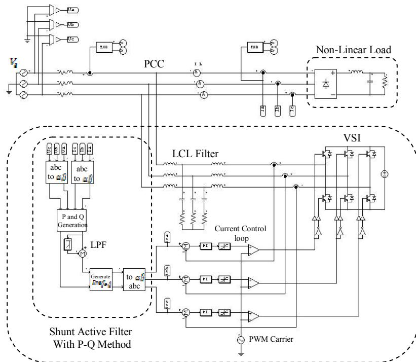
شکل ۳) شبیه‌سازی مدار فیلتر فعال با روش کنترلی P-Q در سیستم قدرت
