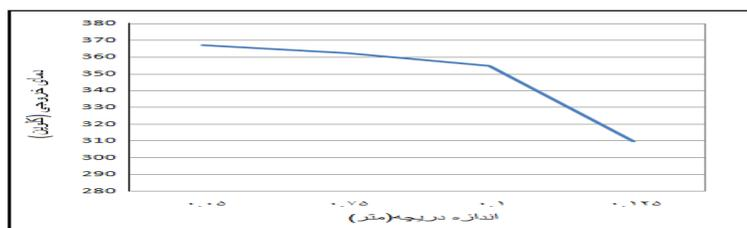
شکل ۵) بررسی اثر اندازه دریچه ورود و خروج هوا
