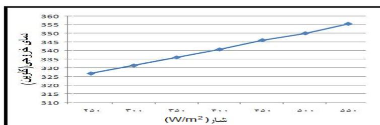
شکل ۶) تاثیر میزان تشعشع روی دمای خروجی
