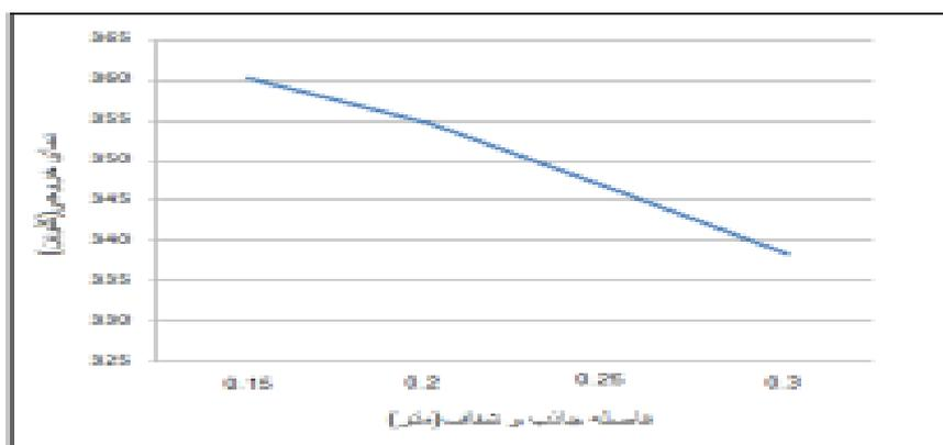
شکل ۴) بررسی اثر فاصله سطح شفاف و جاذب
