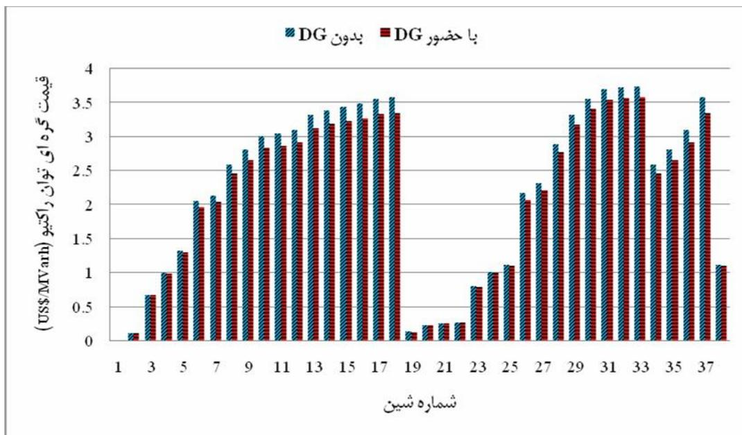
شکل ۵) قیمت گره‌ای توان راکتیو با و بدون DG برای بارهای ترکیبی
