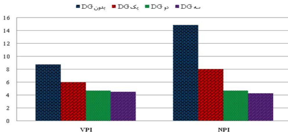
شکل ۸) شاخص پروفیل ولتاژ و قیمت گره‌ای برای بارهای ترکیبی
