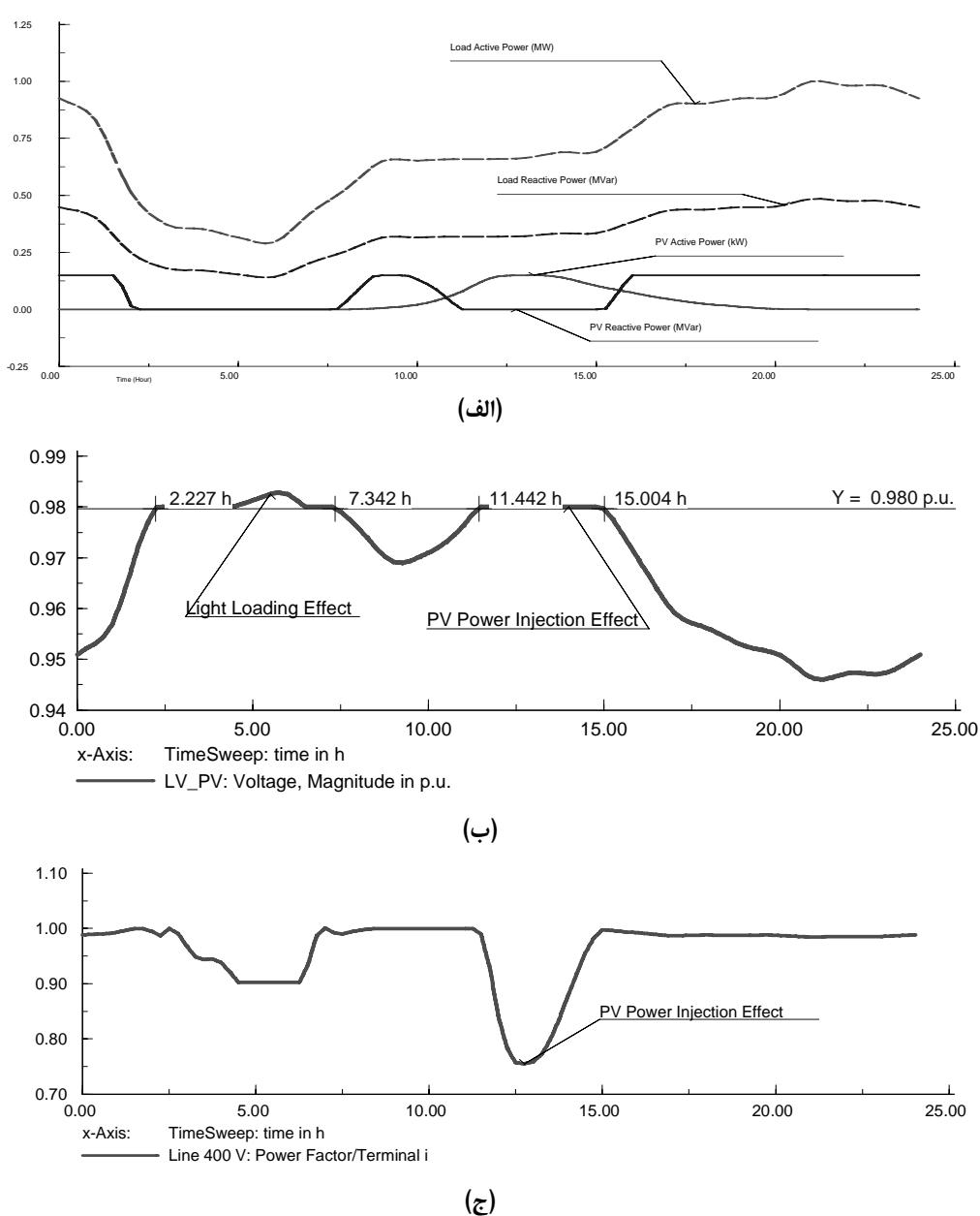
شکل ۱۱: الف- تبادل توان اکتیو و راکتیو بین PV شبکه ب- تلفات شبکه ج- ولتاژ PCC د- ضریب توان
