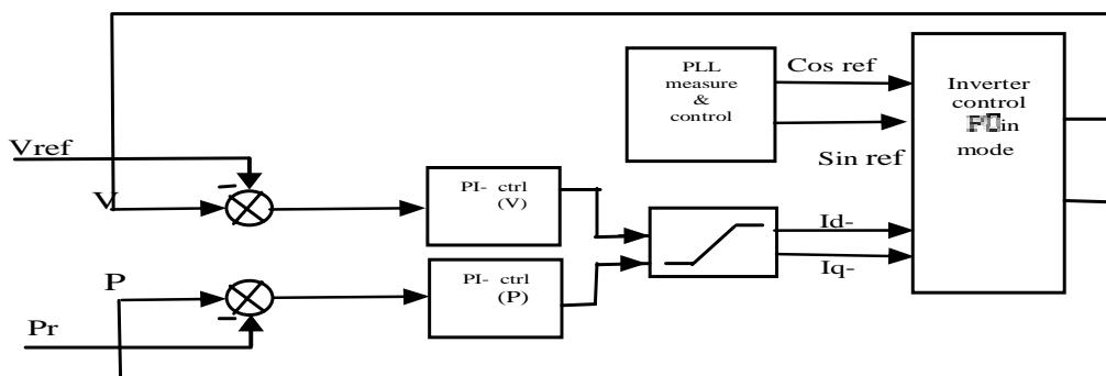
شکل ۵: بلوک دیاگرام کنترل  $\bar{P}U$  به عنوان یک شینه
