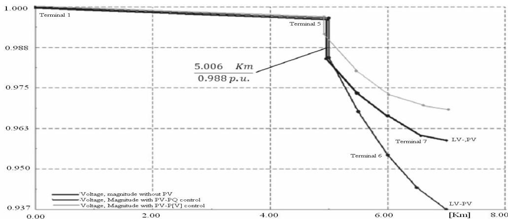
شکل ۴: پروفیل ولتاژ بدون PV، با روش‌های کنترلی PQ و  $\bar{U}P$
