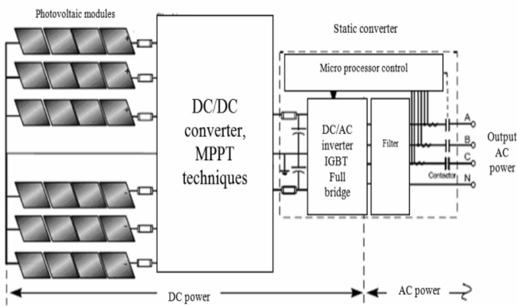
شکل ۱: سیستم فتوولتائیک و اجزای اصلی آن
