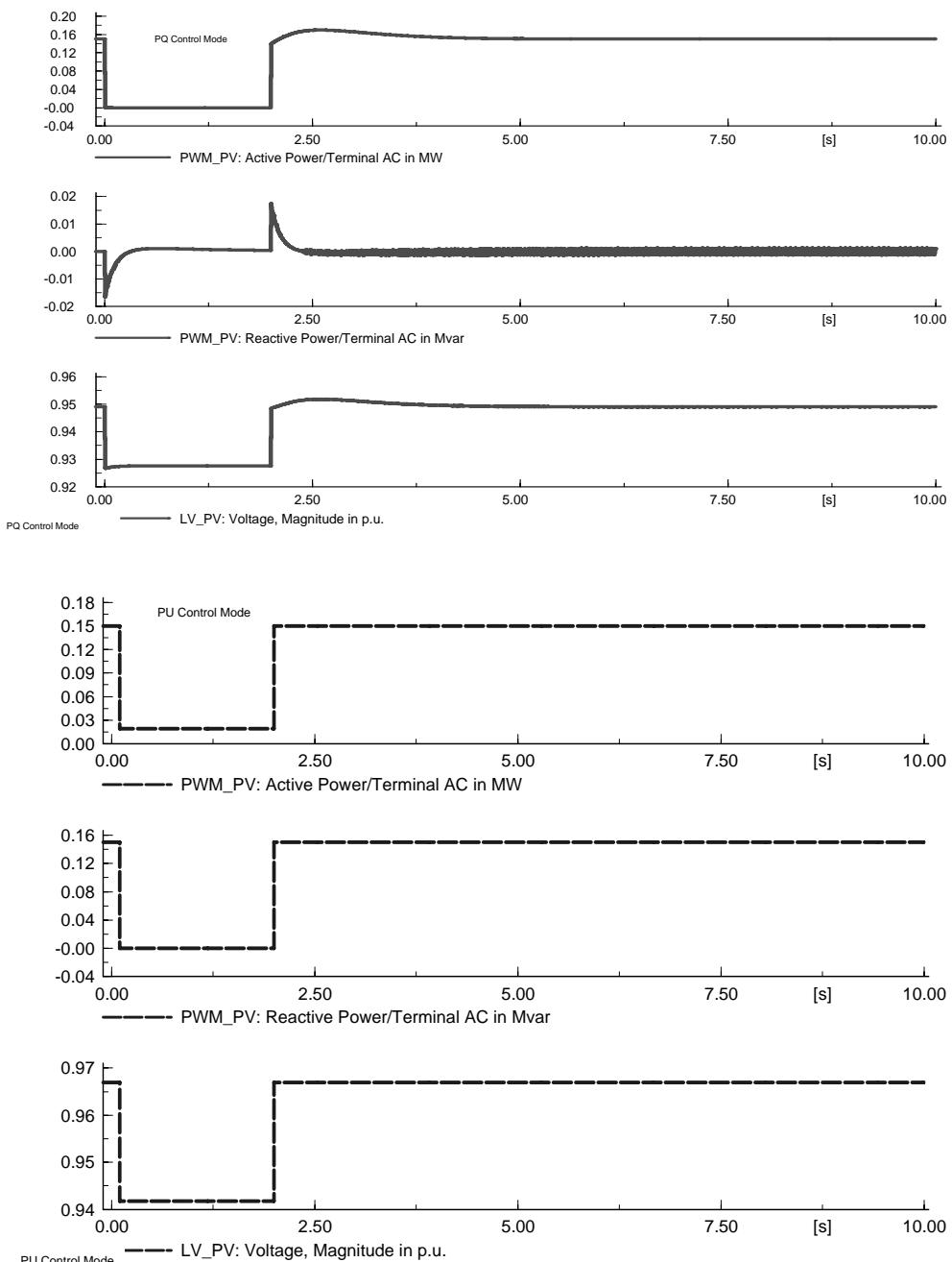
شکل ۷: توان اکتیو، توان راکتیو و پاسخ های ولتاژ برای تابش خورشید تحت مدهای کنترلی  $PQ$  و  $\bar{U}$
