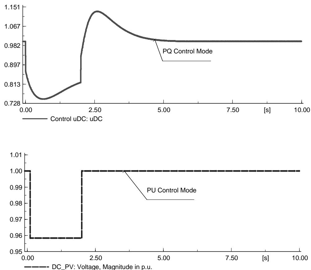
شکل ۸: ولتاژ باس DC در هر دو مد کنترلی
