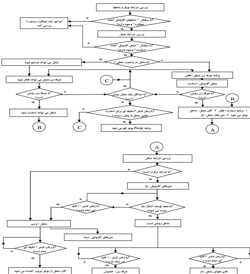
شکل ۱۱: فلوچارت استارت مشعل با سوخت گازوئیل
