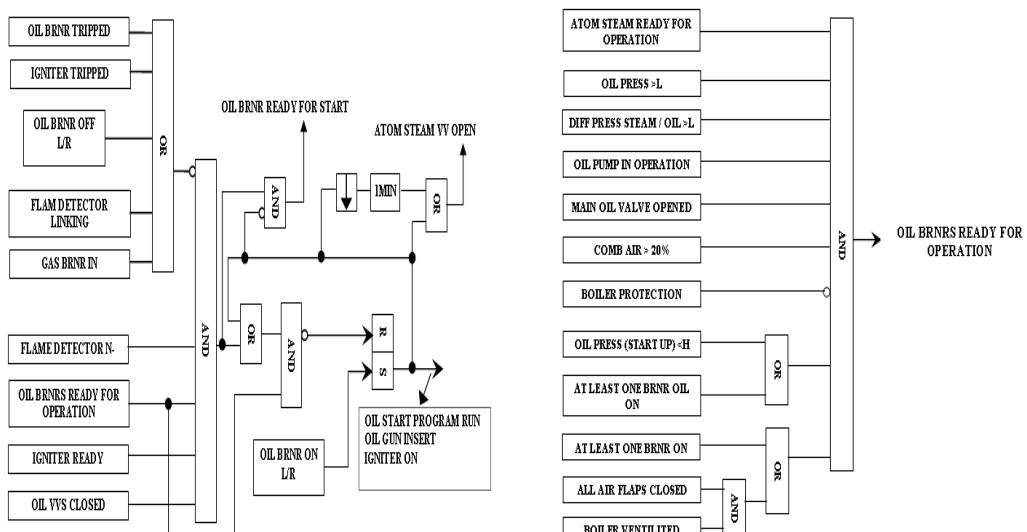
شکل ۱۰: بلوك دیاگرام سیگنال "مشعل گازوئیل آماده روشن شدن"
