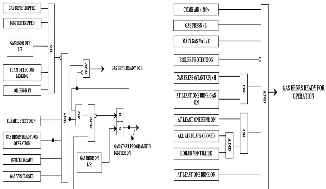
شکل ۱۳: بلوک دیاگرام سیگنال "مشعل گازوئیل
