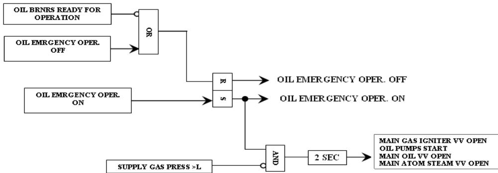
شکل ۶: بلوک دیاگرام منطقی سیستم اضطراری گازوئیل
