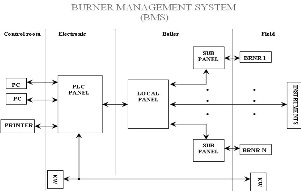
شکل ۱: بلوک دیاگرام قسمتهای مختلف سیستم BMS
