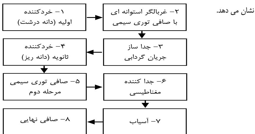
شکل (۴) دیاگرام مکانیزه تبدیل MSW به RDF در روشهای دیگر پس از جداسازی در مبدأ [۶]
