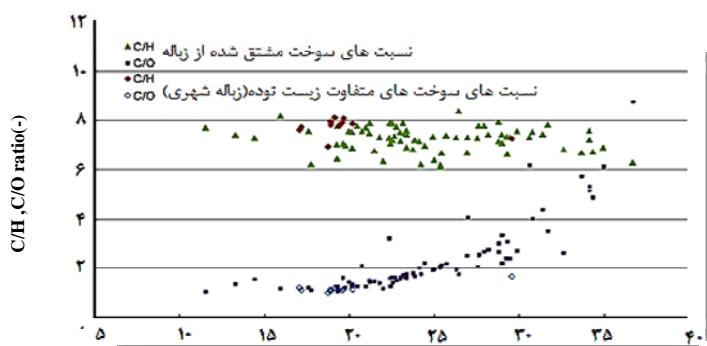
شکل (۳) نسبت C/H و C/O سوخت مشتق شده از زباله و سوخت های متفاوت زیست توده و تاثیر آن در مقدار ارزش حرارتی (MJ/Kg) [۱۶]
