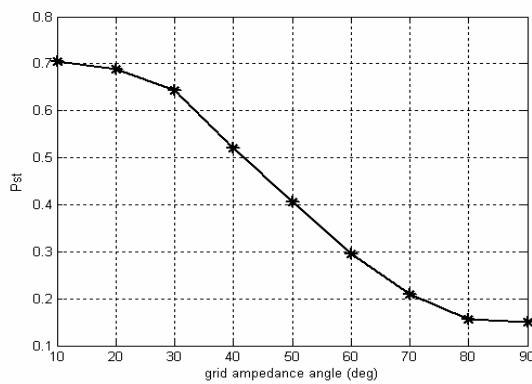
شکل (۱۲) : تغییرات شدت فلیکر کوتاه مدت با زاویه امپدانس شبکه ( $\psi_k = 50^\circ$  ،  $In = 10\%$  ،  $V = 10m/s$ )
