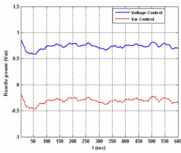
شکل (۱۷): توان راکتیو تحویلی به شبکه در دو روش ارائه شده
