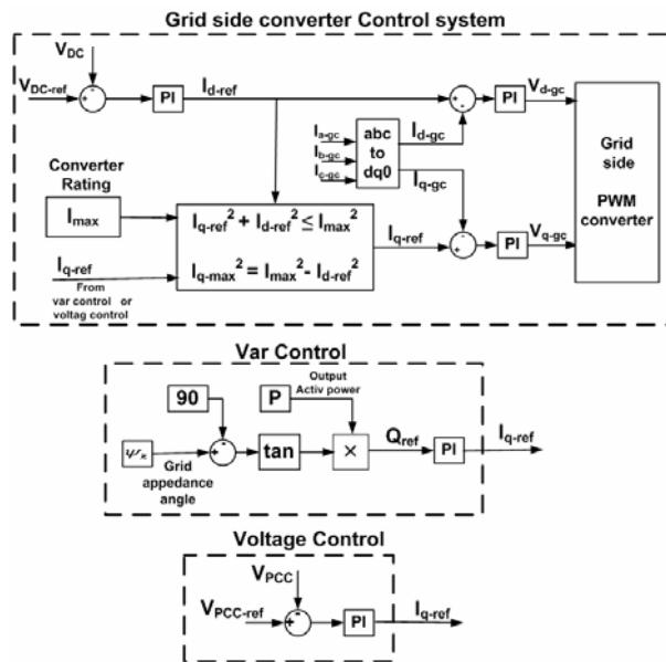
شکل (۱۴) : بلوک دیاگرام کنترل کانورتر طرف شبکه
