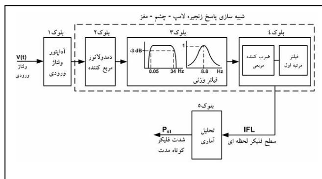
شکل (۶) : بلوک دیاگرام فلیکرمترا طبق استاندارد IEC
