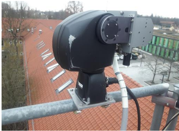
شکل ۱۳. استقرار فعلی سیستم عملیاتی برای اندازه‌گیری جزء تابش فرودی مستقیم
