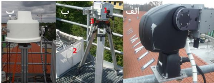
شکل ۴. سیستم‌های ردیاب. الف) دستگاه PTU، ب) سیستم مکانیابی ENEO، پ) سامانه اسکای-اسکنر ۱
