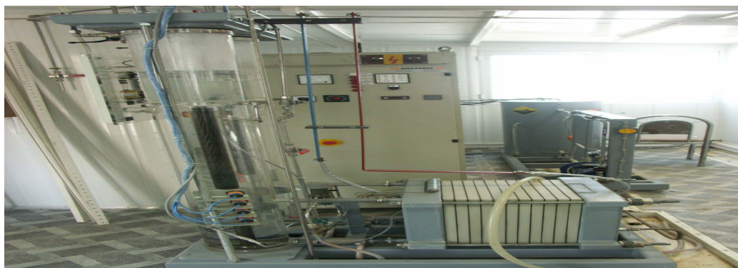
شکل ۵: نمایی از دستگاه الکترولیز آب مدل EV05/10
