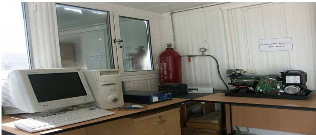
شکل ۶: نمایی از سیستم پیل سوختی پلیمری مدل Nexa1200
