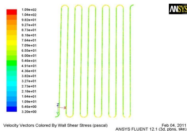
شکل ۱۱: توزیع تنش در بدنه رایزر، Re=30323.5
