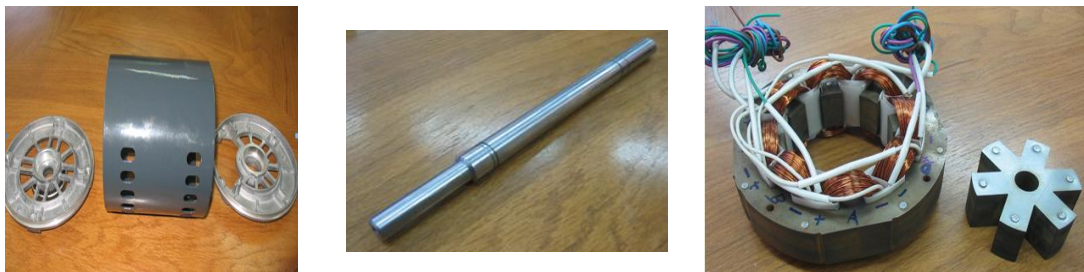
شکل ۱۰: نمایی از روتور، استاتور سیم‌بندی‌شده، شفت، پوسته و درپوش‌های موتور
