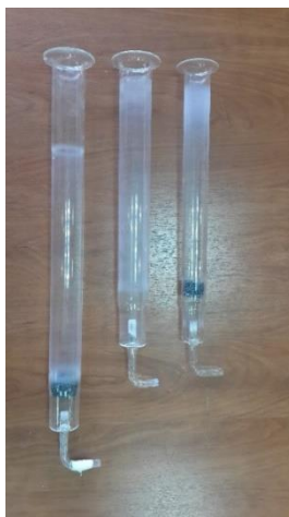
شکل ۳. راکتور احتراقی با طول و قطرهای مختلف
