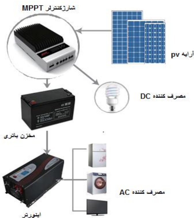
شکل ۲. طرحواره سامانه مستقل فتوولتاییک تولید برق.
