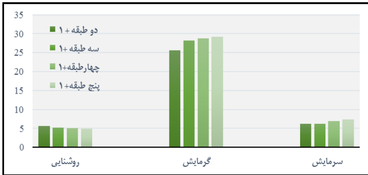
شکل ۹. میزان مصرف انرژی روشنایی، گرمایشی و سرمایشی ساختمان مدرسه با تعداد طبقات مختلف
