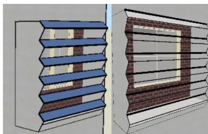
شکل ۸: سایه بان جمع شو (به صورت ریلی) برای پنل های X
