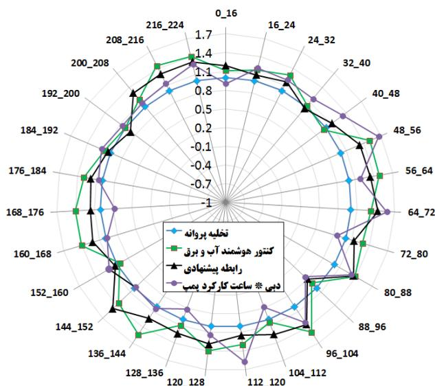
شکل ۷. میزان برداشت آب نرمالیزه شده نسبت به حجم مجاز پروانه (دایره واحد آبی رنگ) به تفکیک بازه عمق چاه‌های انتخابی (کلاسه‌بندی شده). برای اندازه‌گیری از طریق ۱. کنترلر آب (نمودار سبز رنگ) ۲. اندازه‌گیری دبی و ضرب آن در ساعت کارکرد پمپ (نمودار با رنگ بنفش) ۳. روش پیشنهادی (نمودار سیاه رنگ).
